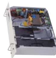
Rack 19" 3U (conexiones a los conectores)
